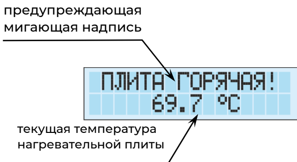
Рис. 9.2 Индикация предупреждения о высокой температуре плиты
